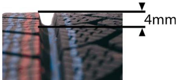
*I pneumatici invernali con profilo inferiore a quattro millimetri non devono essere più immagazzinati. I pneumatici estivi con profilo inferiore a 3 mm non devono essere più immagazzinati.*
