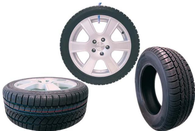
*Conservare i pneumatici montati sui cerchi in posizione coricata o appesi. Aumentare la pressione dell'aria richiesta di 0,4 bar. Immagazzinare i pneumatici smontati in posizione verticale.*
